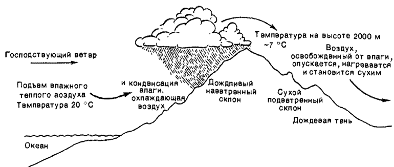
Р и с. 1.4. Орографические осадки и дождевая тень (по Прессу и Сиверу, 1978).
