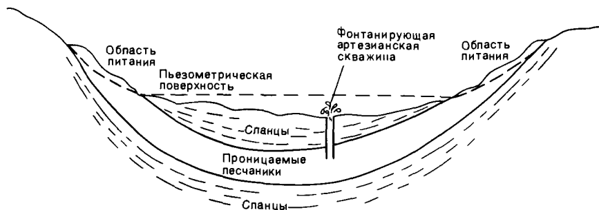
Р и с. 1.12. Упрощенная схема артезианского бассейна в синклинальной структуре. Пьезометрическая поверхность снижается при истечении значительных объемов воды из водоносного горизонта.
