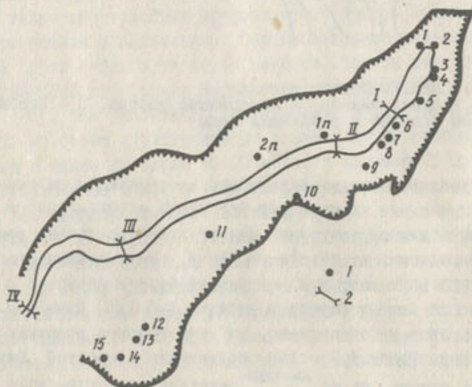
Рис. 1.2. Схема каньона на теле завала: 1 - родники, 2 - створы
