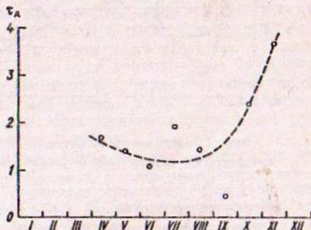
Рис. 4.3. Зависимость сдвига максимума взаимнокорреляционной функции поступления воды и стока \tau_d на леднике Абрамова от времени года.
