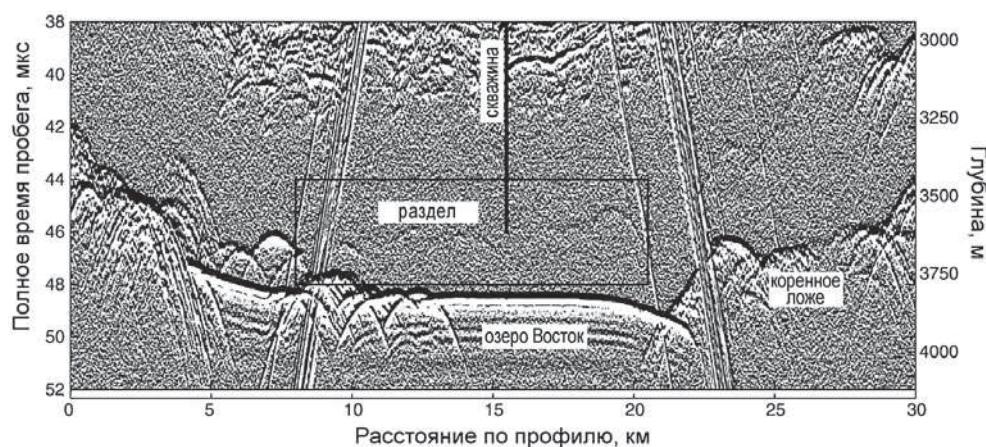
▲ Рис. 4.117. Радарный профиль над южной частью озера Восток. Прямоугольником выделена область с разделом атмосферного и озерного льда (МАИБ), вертикальной линией – положение скважины (MacGregor et al., 2009)
