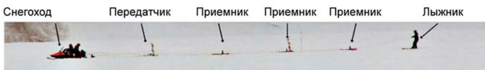
▲ Рис. 2.50. Многоканальные измерения на леднике Бенч на Аляске на частоте 25 МГц. Показана конфигурация системы с расстояниями между передатчиком и приемниками 5, 10 и 15 м (Bradford et al., 2009)
