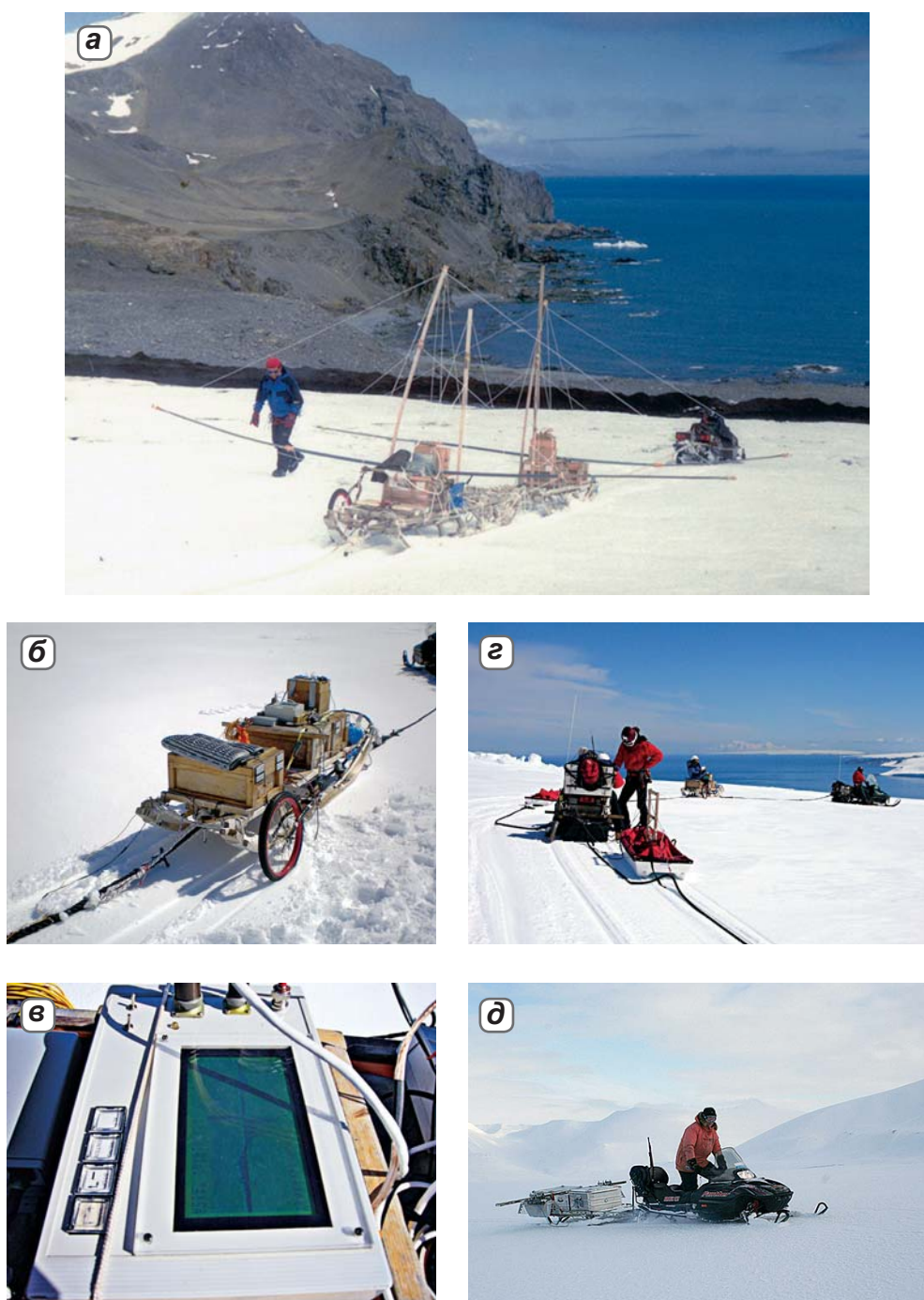
▲ Рис. 3.2. Моноимпульсные локаторы ВИРЛ-2 (а) и ВИРЛ-6 (б) с системой цифровой и регистрации радарных и навигационных данных (в), RAMAC-200 и ВИРЛ-6 (на переднем и заднем плане) (г) и локатор с синтезированной апертурой на частоте 350 МГц (д), применявшиеся в 1999–2007 гг. для радиолокационных и радиофизических исследований ледников на архипелаге Шпицберген и о. Ливингстон
