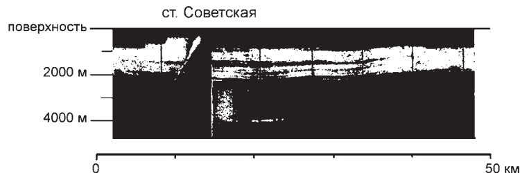
▲ Рис. 2.127. Отражение от подледникового озера на глубине 4200 м в районе станции Советская при аэроадиозондировании на частоте 60 МГц (Robin et al., 1971)
