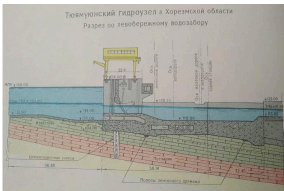
Рисунок 2-8 Разрез по левобережному каналу
