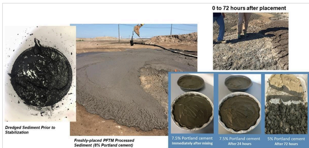
Рисунок 3-25 Переработанные наносы с использованием PFTM
