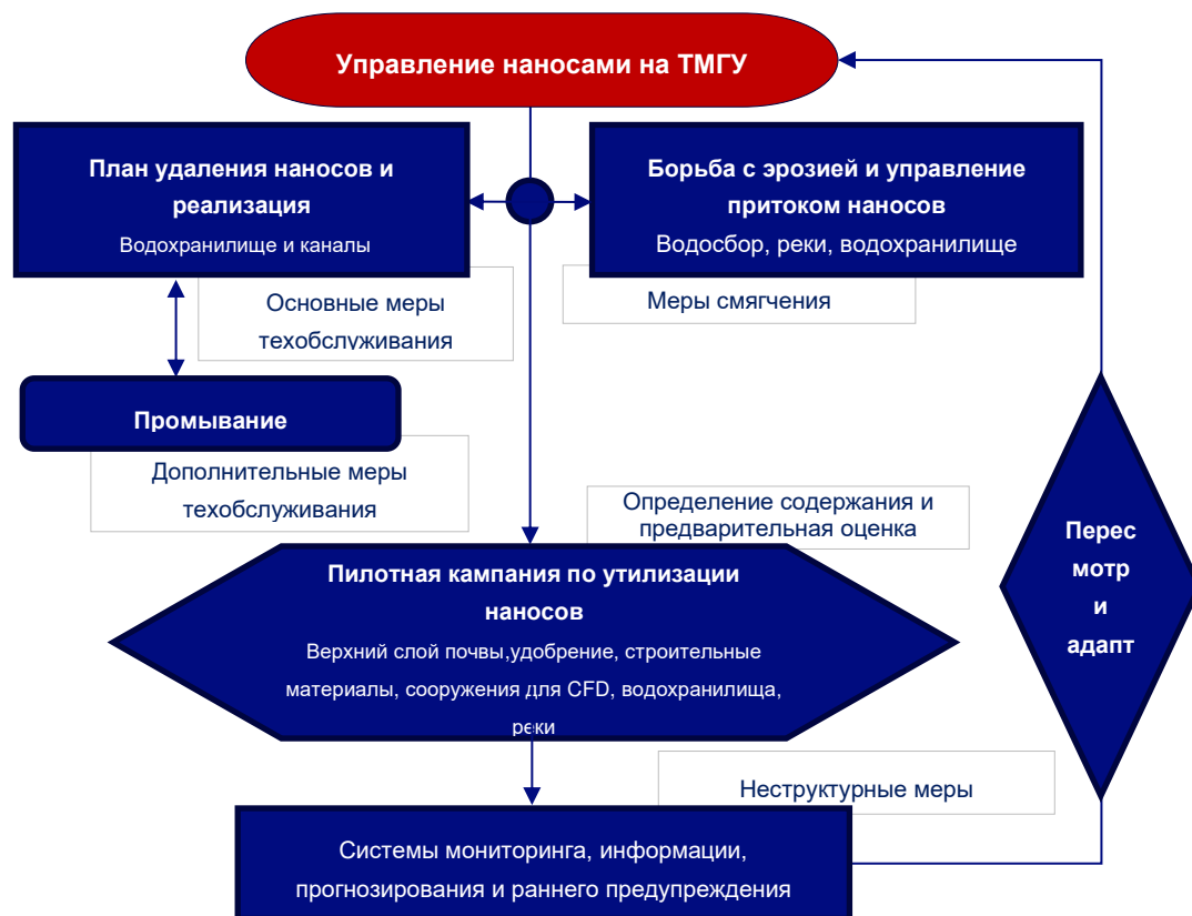
Рисунок 3-13 Базовая техническая концепция комплексного управления наносами на ТМГУ с утилизацией
