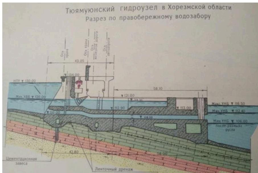
Рисунок 2-9 Разрез по правобережному каналу
