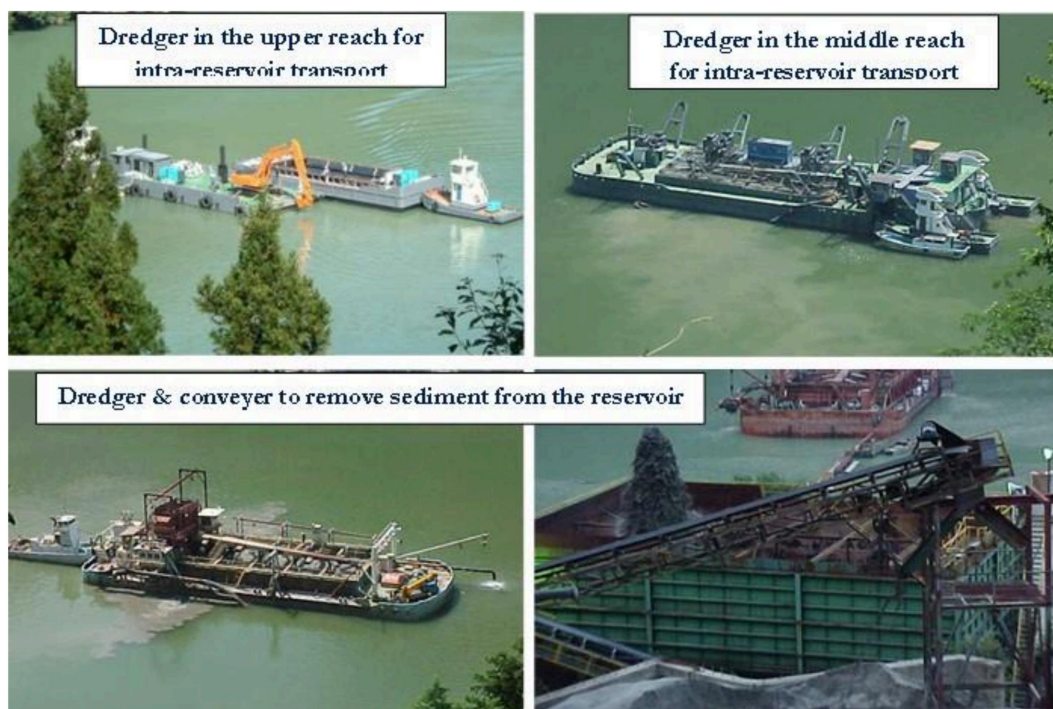
Рисунок 5-8 Механизм дноуглубления и удаления наносов (предоставлено J-Power)
