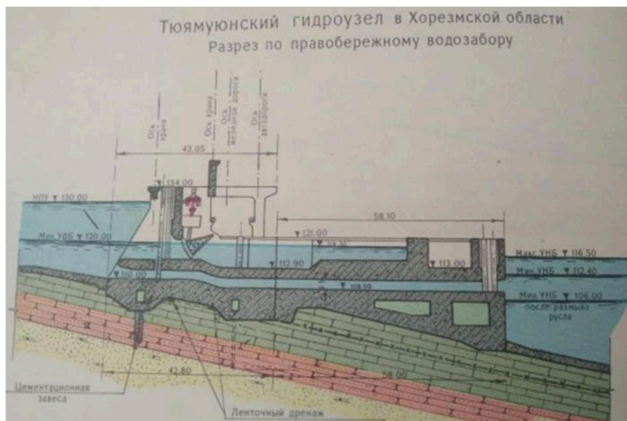
Рисунок 2-9 Разрез по правобережному каналу
