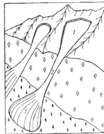
Рис. 4.1. Схема лавиносбора: 1 — зона зарождения лавин; 2 — зона транзита; 3 — зона отложения снега
