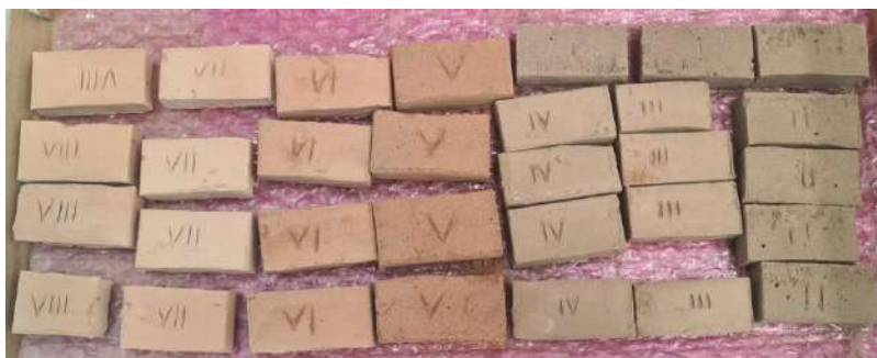
Рисунок 2: Готовые образцы продукта (кирпичи), изготовленные с использованием наносов из Руслового водохранилища
