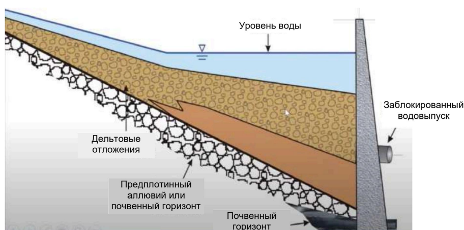
Рисунок 5: Типичные отложения в водохранилище (Рэндл 2018)
