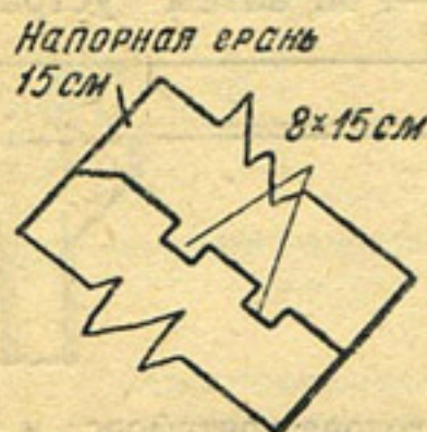
Рис. 54. Рабочий шов напорной плиты плотны Кингздом
