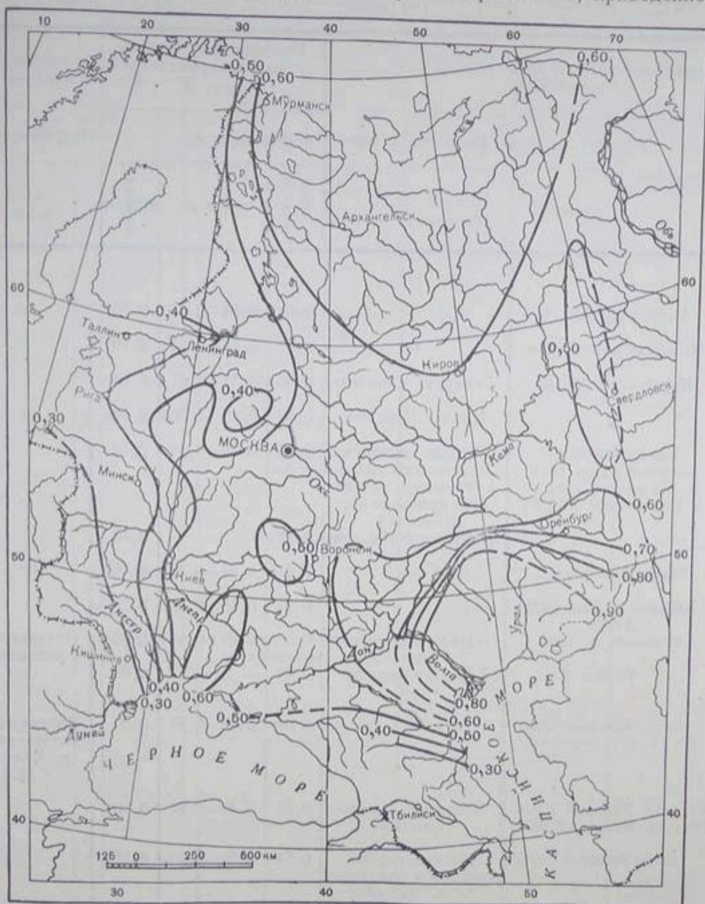
Рис. 28. Картограмма параметра a_d в формуле зависимости коэффициента внутригодовой неравномерности стока от площади и озерности водосбора.
