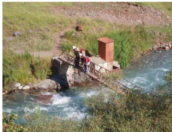
Рис. 1. Измерение скорости течения потока на гидропосту Белогорка.
