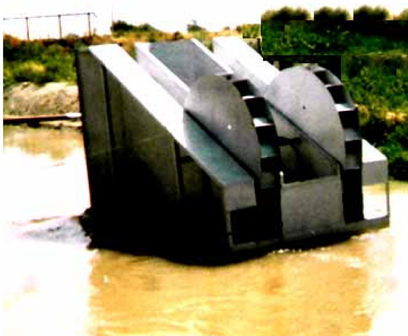
Рис. 2. Натурный образец микроГЭС во время испытания
