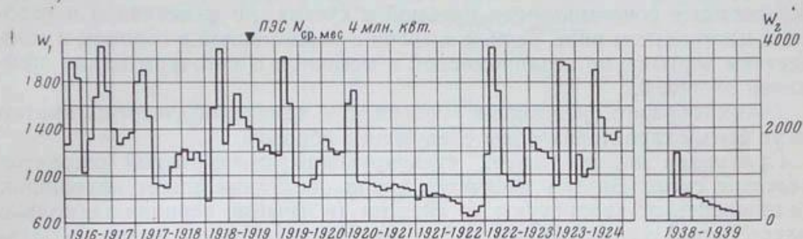
Рис. VI.5. Сравнение колебания среднесуточной мощности речной и приливной энергии N_{ПЭС} — 14 млн. кВт; отдача — 36 млрд. кВт·ч; использование мощности \gamma = 30\% ; N_{ГЭС} — 2,3 млн. кВт; отдача — 10 млрд. кВт·ч; \gamma = 52\% ; W_1 — среднесуточная мощность ГЭС; W_2 — среднесуточная мощность ПЭС
