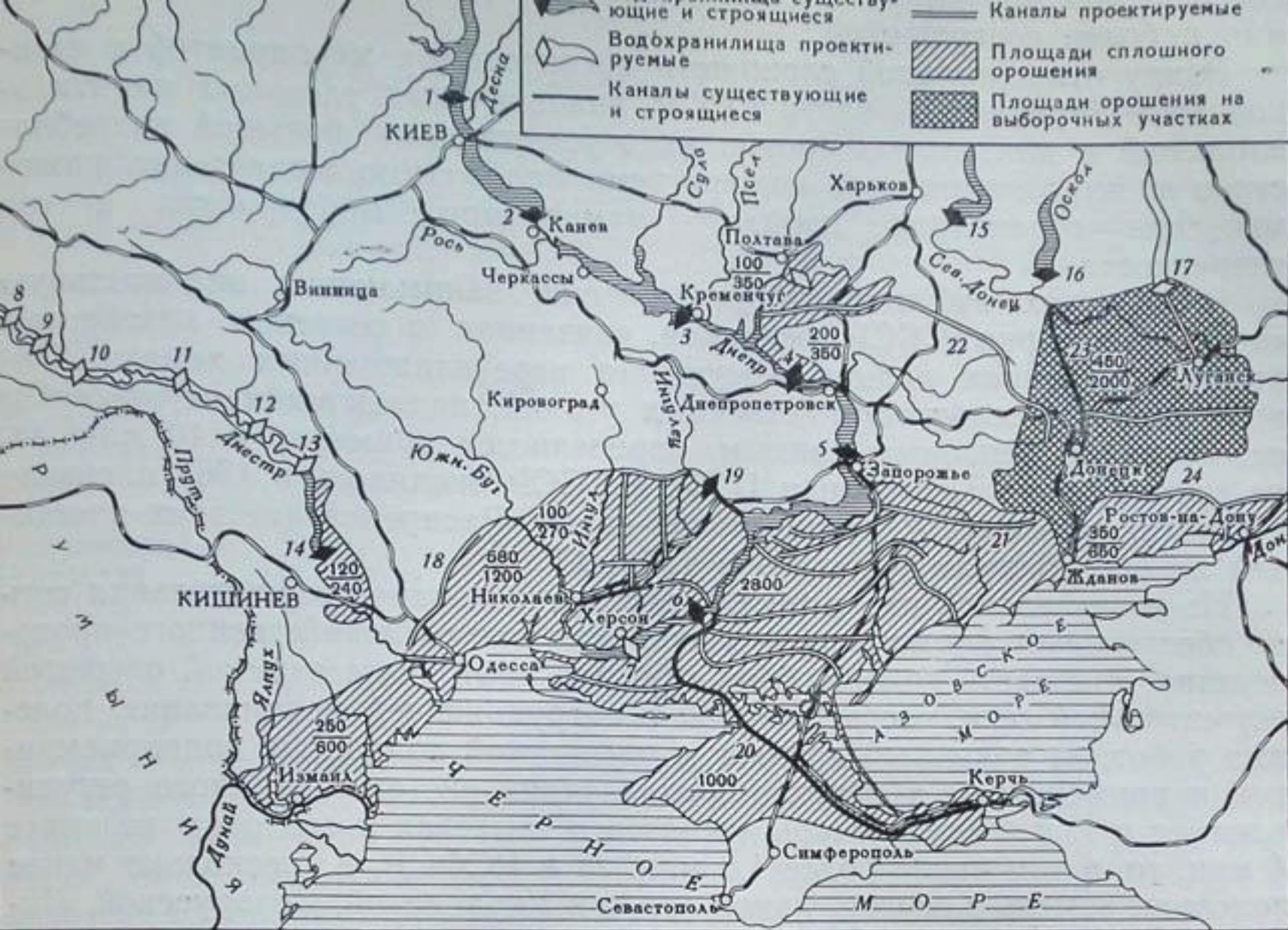
Рис. IX.2. Схема развития орошения на юге Украины и Молдавии. Цифры в пределах орошаемых площадей показывают (в тыс. га): числитель — площадь орошения, нетто; знаменатель — то же, брутто
