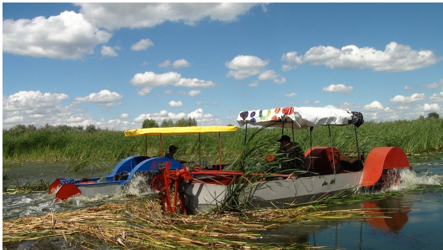
Фото 13. Работы по рыбохозяйственной мелиорации - выкашивание жесткой водной растительности камышекосилкой (Волгоградская область). (Фото Яковлев С.В.)
