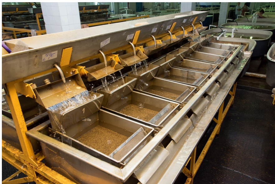
Фото 28. Инкубация икры русского осетра в инкубационном аппарате «осетр». (Волгоградский осетровый рыбоводный завод). (Фото Сытилин П.В.)
