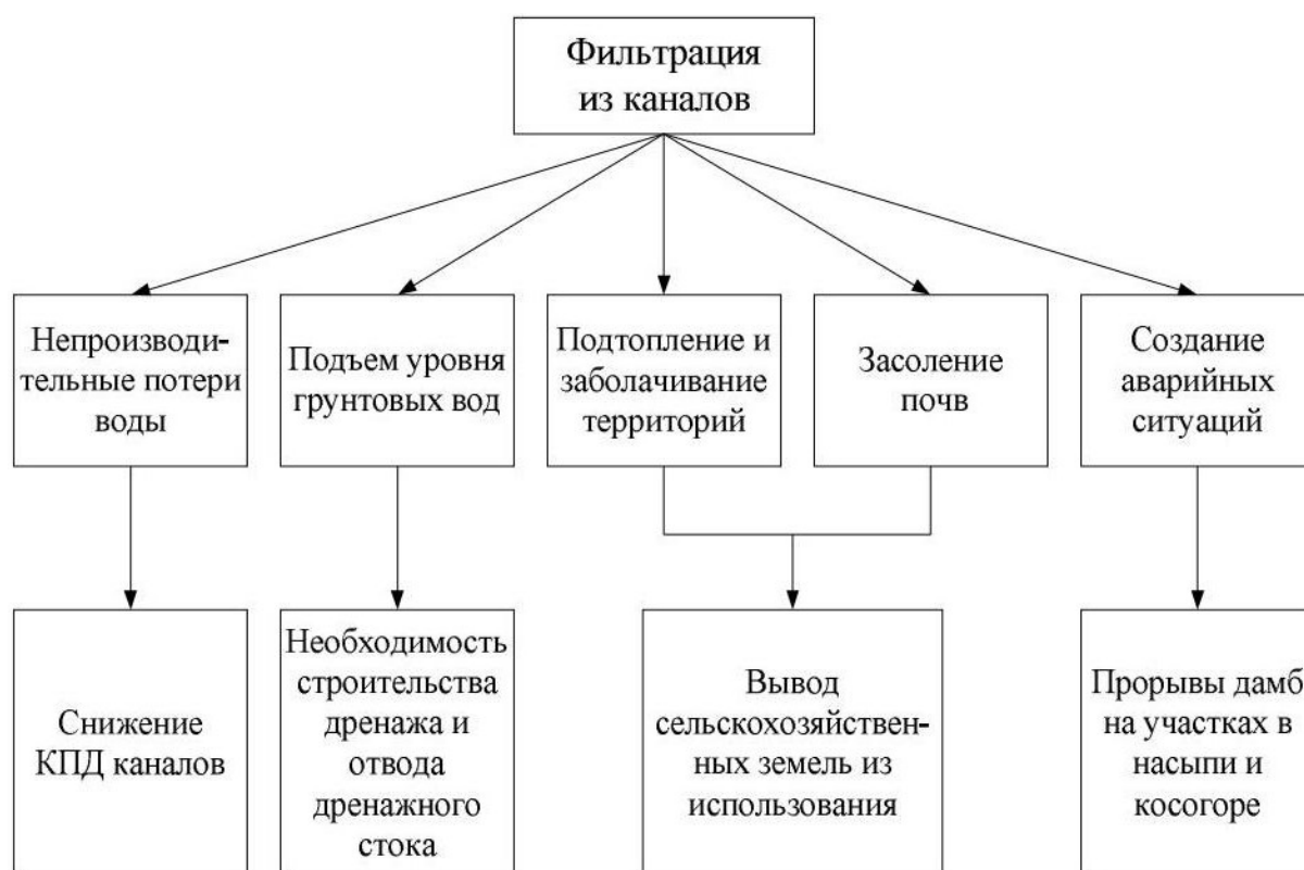
Рис. 4.2. Последствия фильтрации из оросительных каналов
