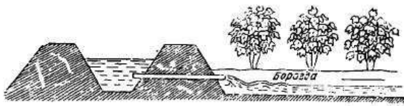
Рис. 2.6 Подача воды в борозды трубочками
