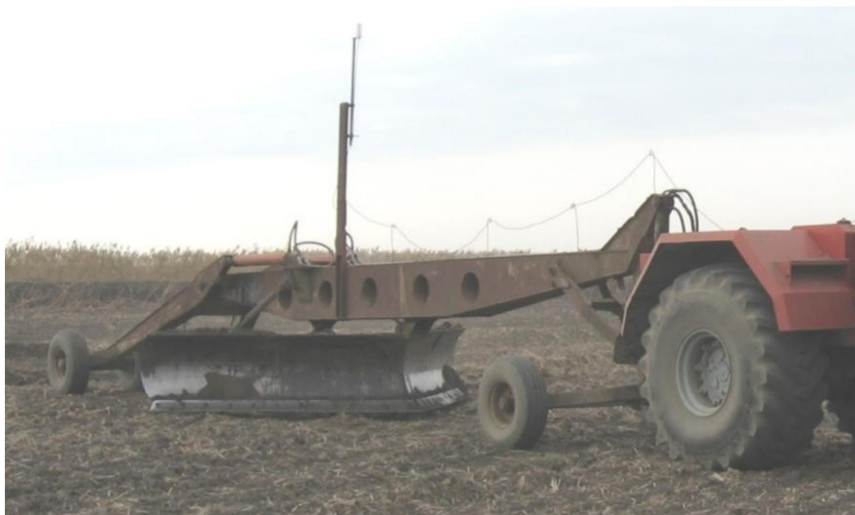
Рис. 3.3 Прицепной клин-планировщик КП-719 с лазерным управлением
