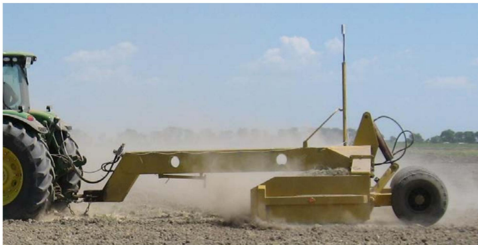
Рис. 3.2 Короткобазовый планировщик ПАУ-4,2 с лазерным управлением
