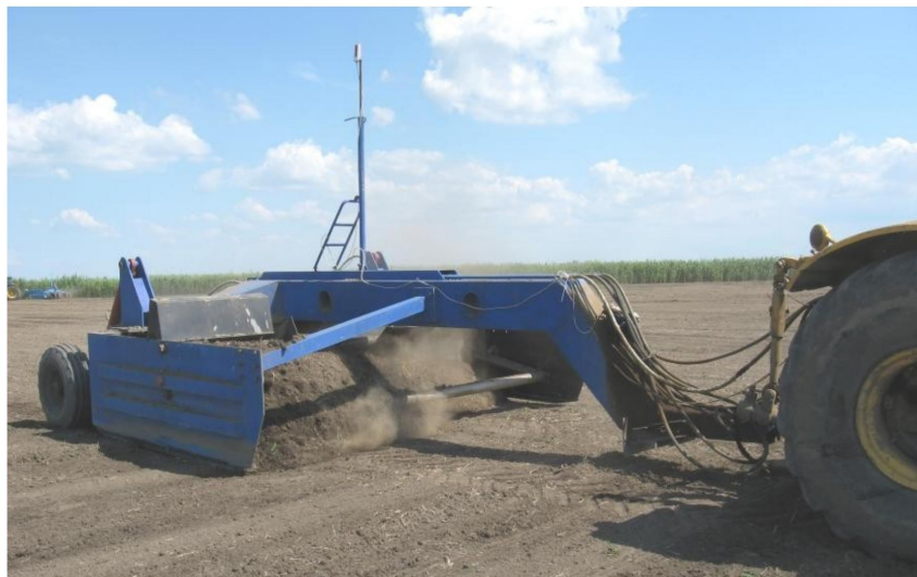
Рис. 3.4 Короткобазовый скрепер-планировщик СП-4,2 с лазерным управлением
