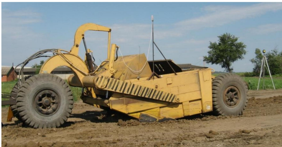
Рис. 3.1 Прицепной скрепер ДЗ-77 с лазерным управлением
