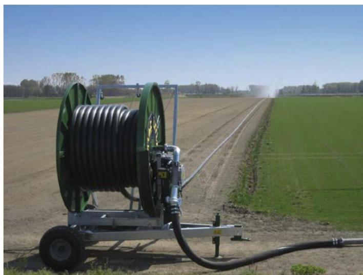
Рис 2.21 Барабанная дождевальная установка
