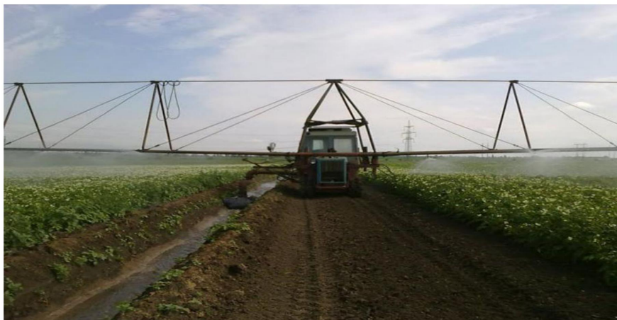
Рис 2.18 Дождевальная машина консольного типа ДДА-100МА
