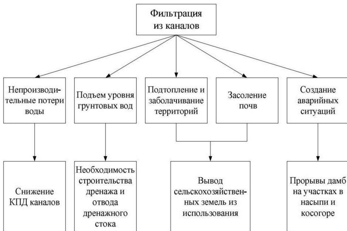
Рис. 4.2. Последствия фильтрации из оросительных каналов
