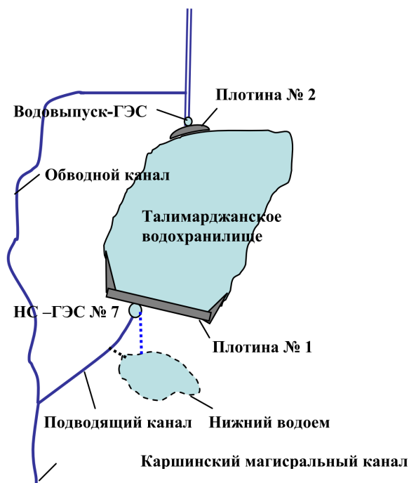
Рис. 1 - Схема Талимарджанского водохранилища
