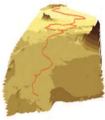
Рис.3. Схема головного водо-солеотводящего тракта в перспективном изображении. Масштаб по вертикали увеличен в 1000 раз.
