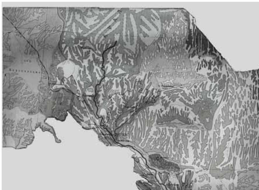
Рис. 2 Выявление с помощью метода «пластики рельефа» особенностей распределения направлений водных потоков и особенностей макрорельефа дельты реки Амударьи. Для уточнения микрорельефа использовали космоснимки Google.
