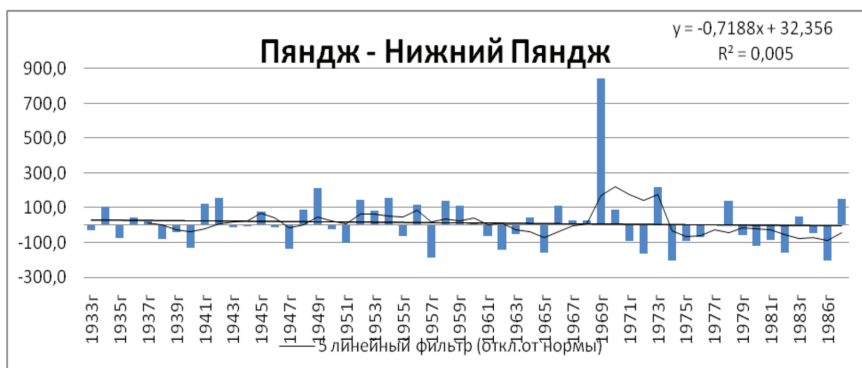
Рис. 4.10. Изменение расходов воды (м³/с) на р. Пяндж пост Нижний Пяндж за период наблюдений с 1933 по 1987гг.
